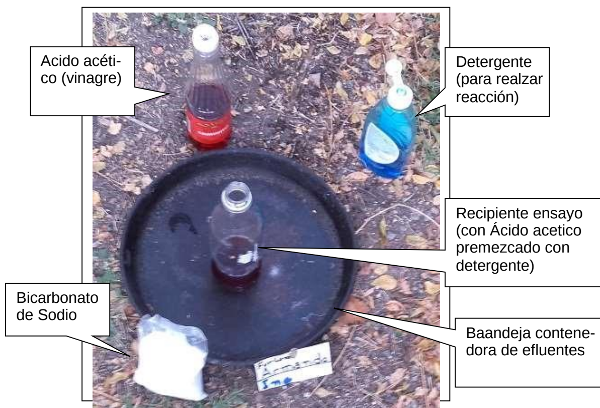
Fig 2.1 Preparacion ensayo: Reactividad
