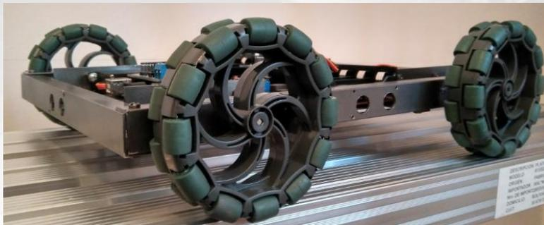
Entre las características notables esta la **Autonomía** de desplazamientos, la capacidad de **resolver obstáculos**, **trayectorias**, y el **posicionamiento** sin intervención asistida.
