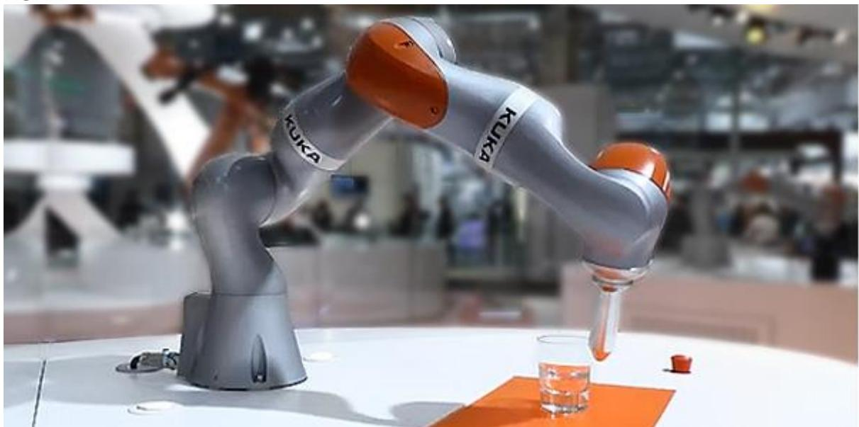
innovación robótica con capacidades sensoriales para la seguridad, rápido aprendizaje del robot y sencillo manejo. Dispone de 7 ejes y un alcance máximo de 800mm con protección IP54. Modelo: LBR iiwa. Capacidad de carga: 7Kg / 14Kg
