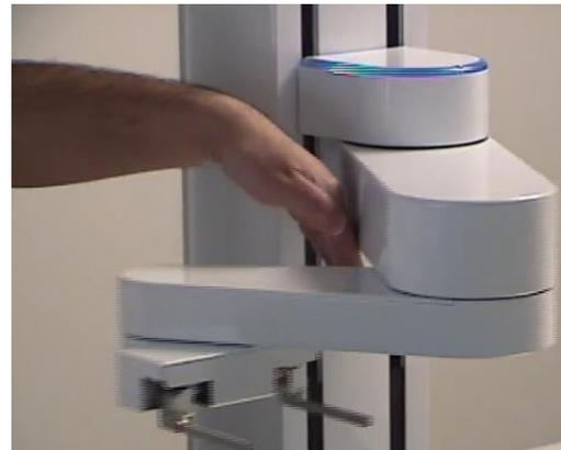
El PF400 es el primer robot SCARA colaborativa del mundo. Dispone de 4 ejes y todas las fuerzas generadas por este mecanismo son limitadas por lo que el robot no puede hacer daño a un usuario, incluso si choca con ellos a toda velocidad. PF400 reduce significativamente el tamaño y el costo de una célula automatizada
