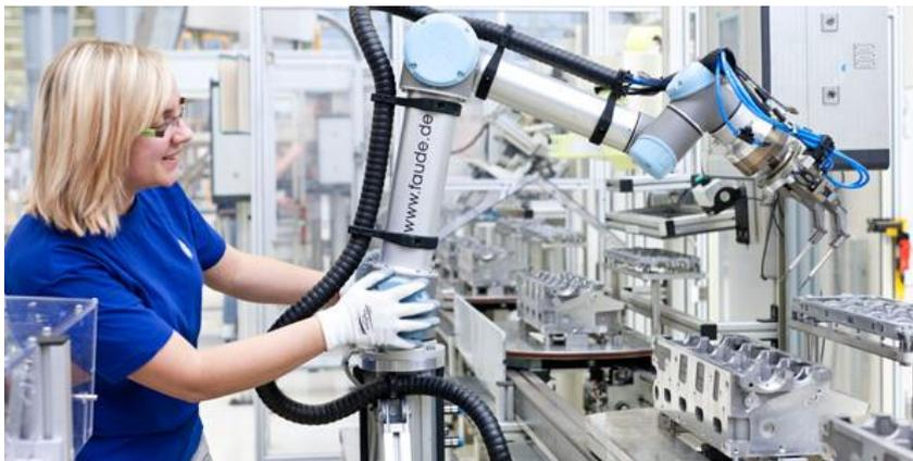
La filosofía de Universal Robots es hacer la robótica accesible a todo el mundo, y en particular facilitar la implementación de la robótica en las PYMES. Dispone de tecnología de sensores que permite limitaciones de movimiento en función de la fuerza ejercida medida por el consumo de los motores.
