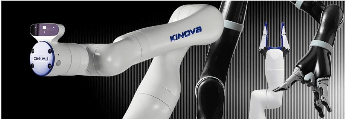
Herramienta robótica portátil ligera que permite a los usuarios interactuar con su entorno, con total seguridad. Dispone de 6 Ejes y solo pesa 5.7 Kg y un alcance de 90 cm. Dispone además de una pinza de 3 dedos con movimientos independiente. Puede trabajar con agua ya que tiene una protección IPX2.
