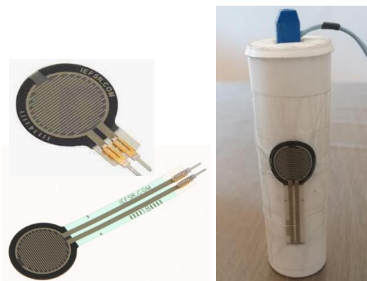
Figura 2. Sensor de Fuerza y Dispositivo implementado para medir. Laboratorio de Robótica.
