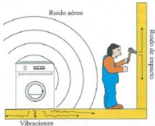
Imagen 4: El ruido aéreo y las vibraciones son otros tipos de ruido caracterizadas según su forma de propagarse y producirse
