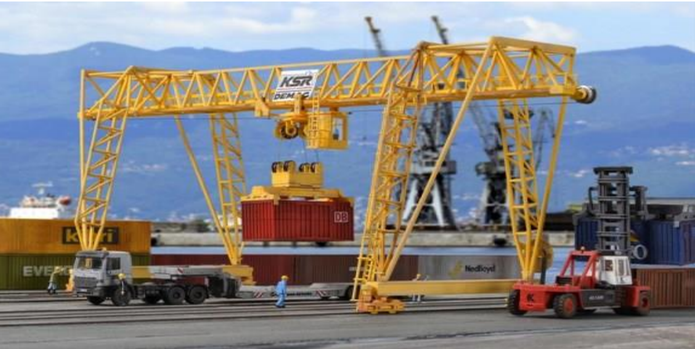
Grúa de puerto con Reticulados Espaciales
