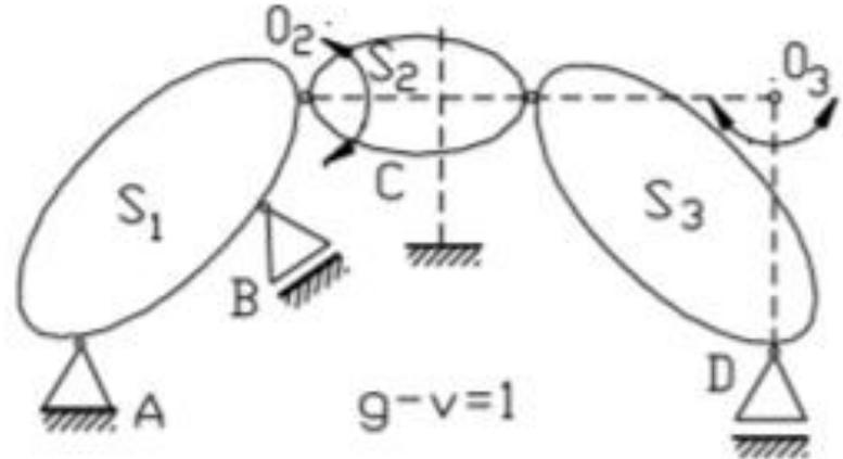
Al sacar C permite girar chapa S2 en O2. Y además chapa S3 podría girar en O3 al desplazarse horizontalmente en D.
