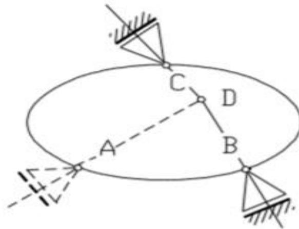
Apoyo A no sería eficiente porque permite giro en D
