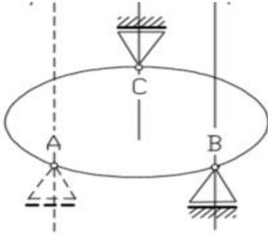
Apoyo A no sería eficiente porque permite despl. Horizontal
