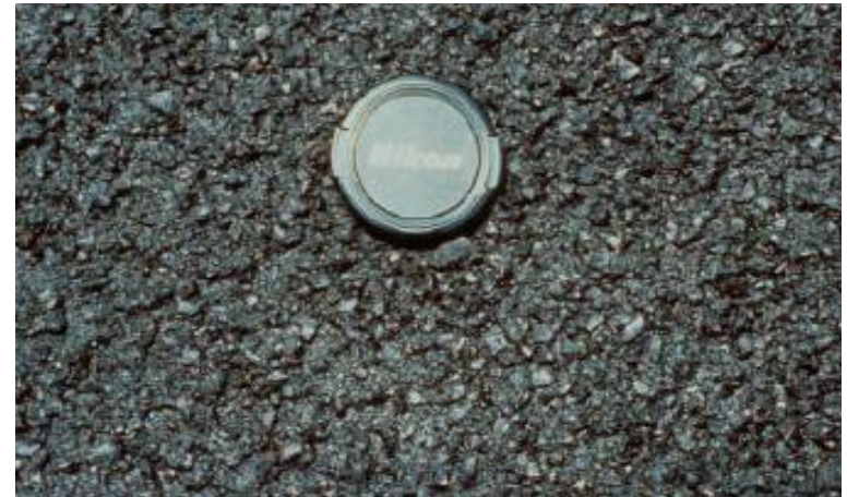
Después de la rotura de la emulsión
