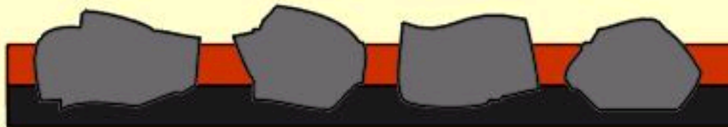
Etapa 2 - lechada asfáltica
