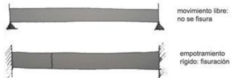
fisuras por retracción hidráulica
