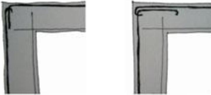
disposiciones erróneas de armaduras traccionadas, por estar interrumpidas en el punto de mayor esfuerzo en la esquina
