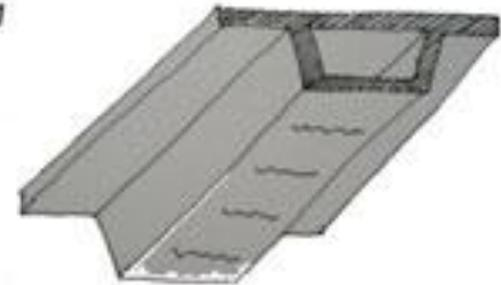
por contracción térmica de la losa inferior de una pieza de sección tubular
