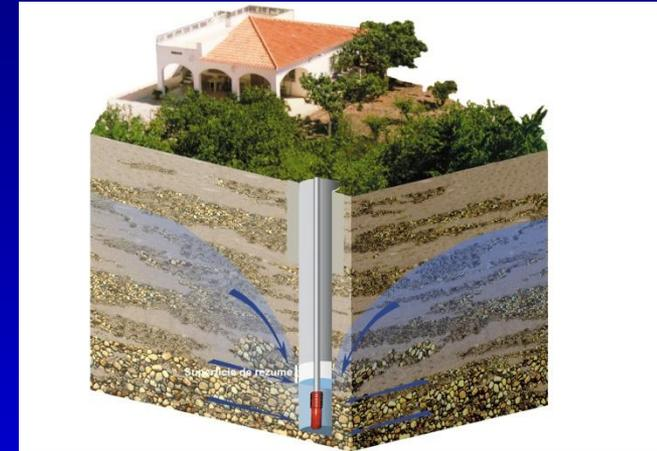
En los pozos se produce un **gradiente hidráulico** para permitir el movimiento del agua hacia el pozo. Si no se produce el descenso de niveles no hay movimiento de agua. Los niveles van descendiendo cerca del pozo hasta que el **caudal que aporta el acuífero se iguala con el caudal bombeado**. Si los niveles no se estabilizan el bombeo puede secar el acuífero.
