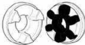
En los acoples estrella conocidos también como tipo TUPAC, la cupla es transmitida a través de una estrella de goma resistente al aceite ubicada entre dos medios cuerpos de fundición. La estrella o cruceta permite hasta 2° de desalineación angular entre los ejes, absorbe marchas, contramarchas, vibraciones e impulsos. Con su uso se evita el desgaste de rodamientos y cojinetes debido a que su relación peso-potencia es baja. Su repuesto es económico y de fácil recambio.
