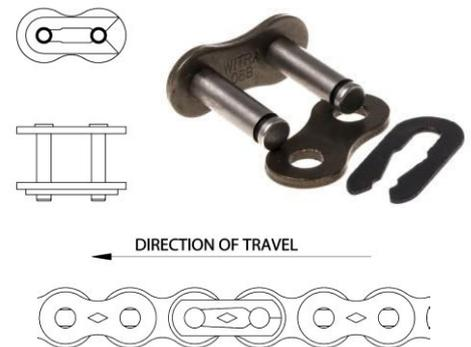
Figura 8-28: eslabón de unión con seguro elástico.
