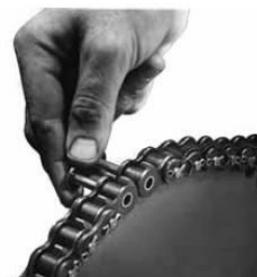
Figura 8-26: eslabón de unión
