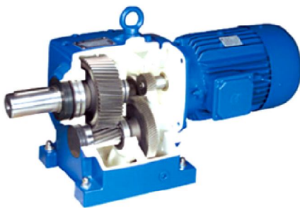
Figura 6-12 Motoreductor de 2 etapas concurrente de dentado cilíndrico helicoidal
