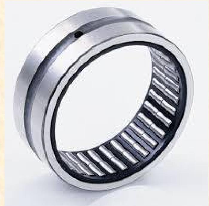
Los rodamientos de agujas son rodamientos con rodillos cilíndricos largos y delgados en relación con su diámetro. A pesar de su pequeña sección transversal, tienen una gran capacidad de carga y, por lo tanto, son muy apropiados para disposiciones de rodamientos con un espacio radial limitado.
