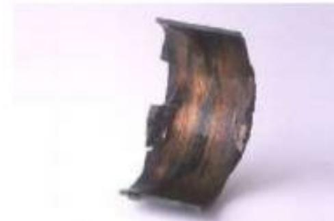
Cojinete desgastado por falta de lubricación. 10
