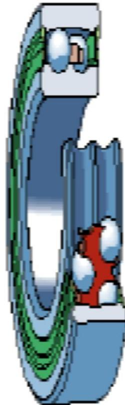
**Rodamiento de doble hilera de bolas donde la pista del aro exterior tiene forma esférica. Esto le da la ventaja de autoorientarse y compensar posiciones de inclinación entre eje y soporte. No son aptos para fuerzas axiales importantes.**
