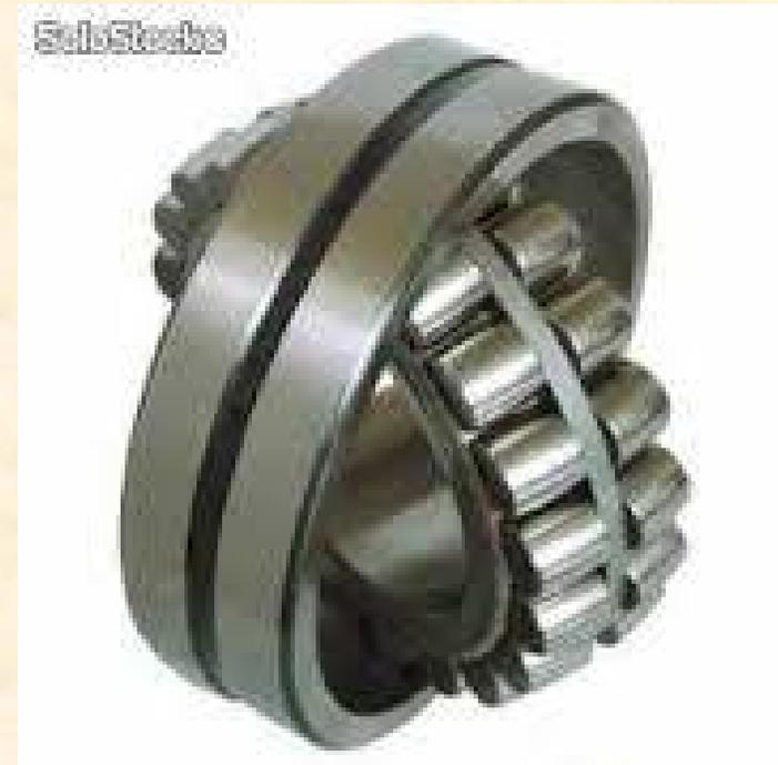
Los rodamientos oscilantes de rodillos son unidades constructivas autoretenidas de dos hileras, formadas por anillos exteriores macizos con pista de rodadura cóncavo-esférica, anillos interiores macizos, así como rodillos en forma de tonel, con jaulas. Los rodillos simétricos en forma de tonel, se adaptan fácilmente a la pista de rodadura cóncavo-esférica del anillo exterior. De esta manera, compensan las flexiones de los ejes y los errores de alineación de los apoyos.
