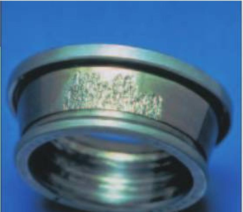
**(2) Agarrotamiento:** Condición en la que, debido al calor, la pistas de rodadura, la brida, y el elemento de rodamiento cambian de color y desarrollan depósitos y ablandamiento.
