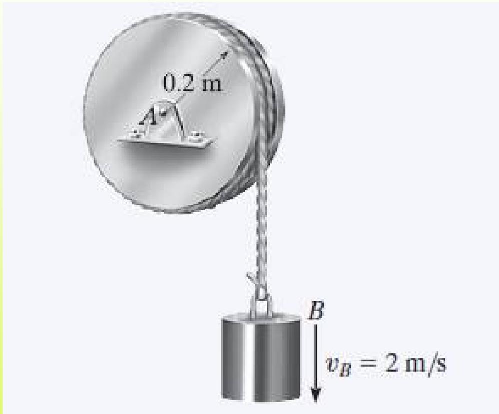
**Ejerc. N° 4) El bloque tiene masa de 6 kg. Está unido a una cuerda enrollada sobre la periferia de un disco de 20 kg que tiene un momento de inercia de 0,40 kg. m<sup>2</sup>.**
