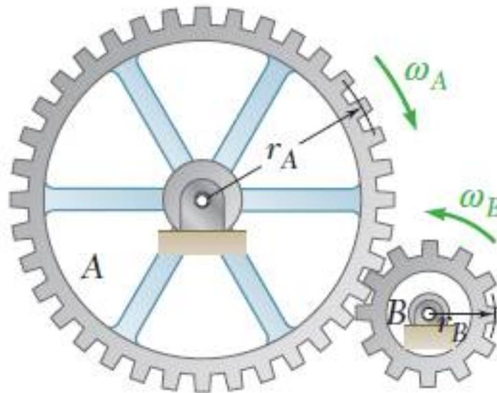
**Energía cinética.** Puesto que el sistema se encuentra inicialmente en reposo,  $T_1 = 0$ . Al sumar las energías cinéticas de los dos engranes cuando  $\omega_B = 600$  rpm, se obtiene
