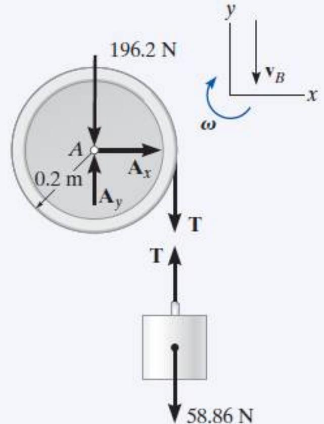
**Cinemática.** Como  $\omega = v_B/r$ , entonces  $\omega_1 = (2 \text{ m/s})/(0.2 \text{ m}) = 10 \text{ rad/s}$  y  $\omega_2 = (v_B)_2/0.2 \text{ m} = 5(v_B)_2$ . Al sustituir y resolver las ecuaciones simultáneamente para  $(v_B)_2$  obtenemos
