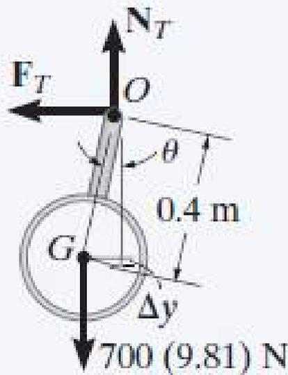
EL peso realiza trabajo puesto que desciende una distancia vertical de  $0,4 \text{ m} - 0,4 \cos 30^\circ = 0,05359 \text{ m}$
