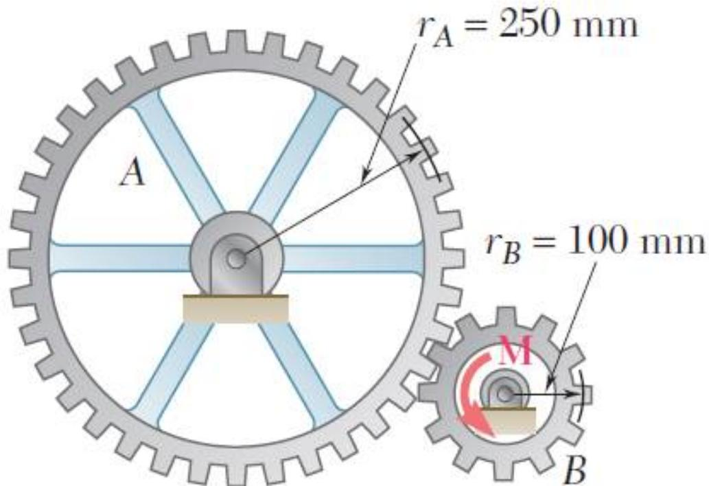
**Ejerc. N° 2) El engrane A tiene una masa de 10 kg y un radio de giro de 200 mm, el engrane B tiene una masa de 3 kg y un radio de giro de 80 mm. El sistema está en reposo cuando un par de 6 N.m se aplica al engrane B. Si se ignora la fricción, calcular a) el número de revoluciones ejecutadas por el engrane B antes de que su velocidad angular llegue a 600 rpm b) la fuerza tangencial que el engrane B ejerce sobre el engrane A.**
