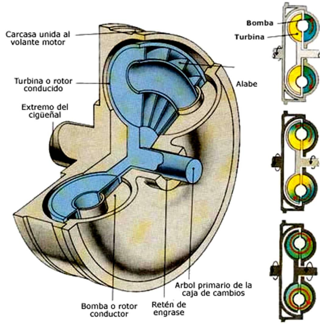
**Marcha lenta o ralenti:** A esta velocidad el volante motor mueve la bomba o rotor conductor impulsando el aceite con tan poca fuerza que es incapaz de mover la turbina o rotor conductor por lo que el vehículo no se mueve.
