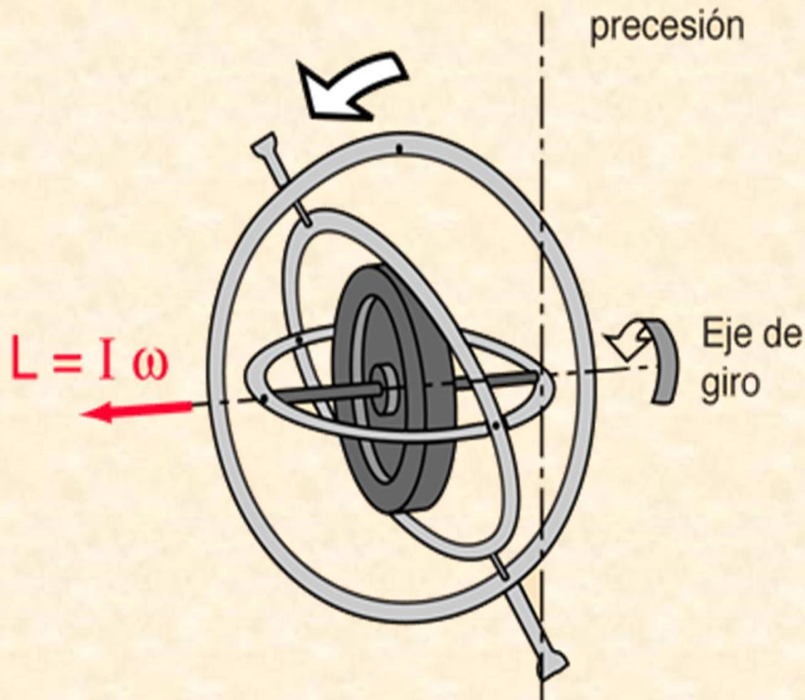
Si un **giroscopo** se inclina, el sistema cardánico tratará de reorientarlo para mantener el eje de giro del rotor en la misma dirección. Si se libera en esta orientación, el giróscopo hará un movimiento de **precesión** en la dirección mostrada, como consecuencia del **par** ejercido por la gravedad sobre el giróscopo.
