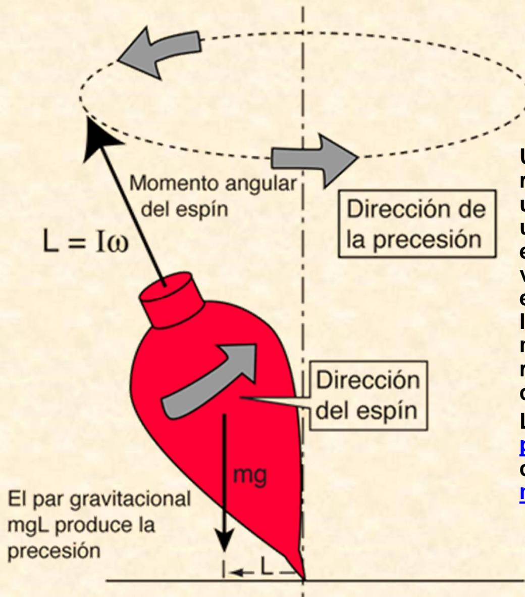
Un trompo que gira rápidamente, precederá (realizará un movimiento de precesión) en una dirección determinada por el par ejercido por su peso. La velocidad angular de la precesión es inversamente proporcional a la velocidad angular del giro, de manera que la precesión es más rápida y mas pronunciada, cuando se va parando el trompo.
