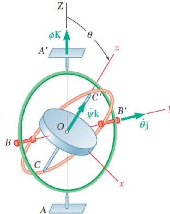
Un giróscopo consiste en un rotor que puede girar libremente alrededor de su eje geométrico. Cuando está montado en una suspensión asume cualquier orientación, pero su centro de masa debe permanecer fijo en el espacio.
