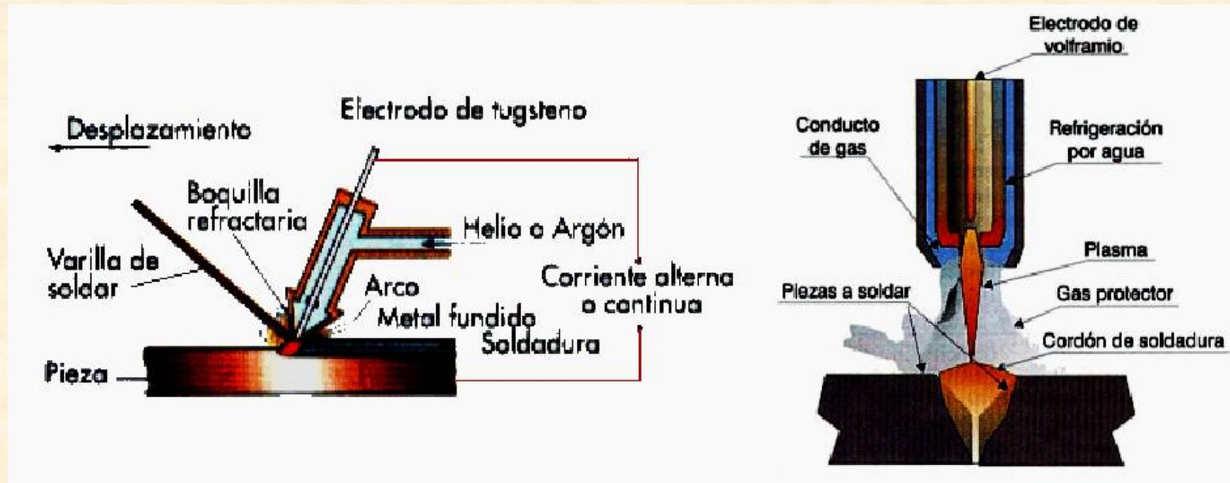
El arco salta entre el electrodo de Wolframio o Tungsteno (que no se consume) y la pieza, el metal de aporte es una varilla sin revestimiento de composición similar a la del metal base.
