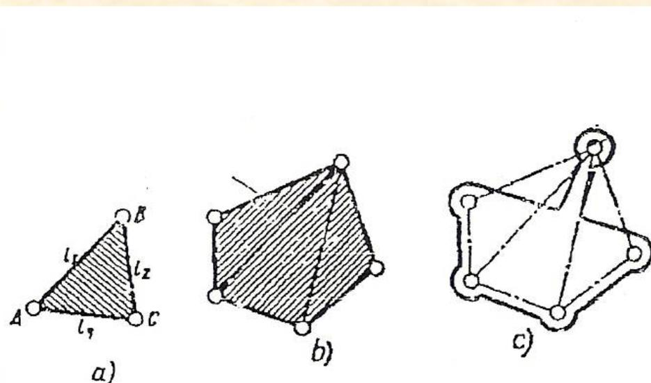
Fig.19. Representaciones convencionales de un elemento a: que forma parte de tres pares giratorios; b: que Constituye cinco pares de giro; c: forma real del mismo.
