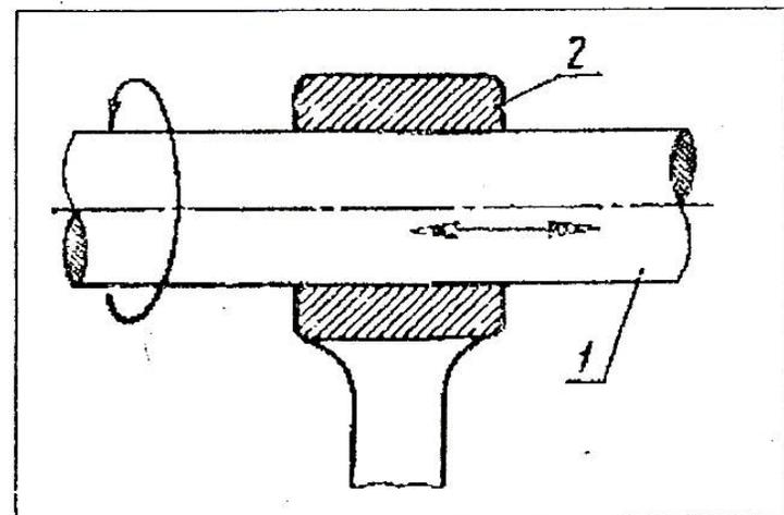
Figura 6 : par cinemático de dos movimientos (cilíndrico)
