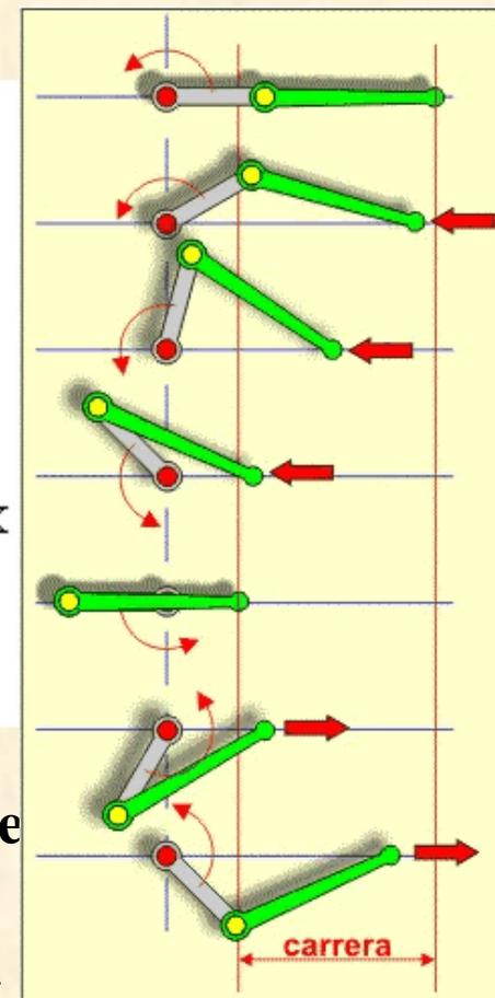
Supongamos que la manivela tiene radio  $r$ , y la biela tiene una longitud  $l$  ( $l > 2r$ ).
