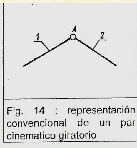
Fig. 14 : representación convencional de un par cinemático giratorio
