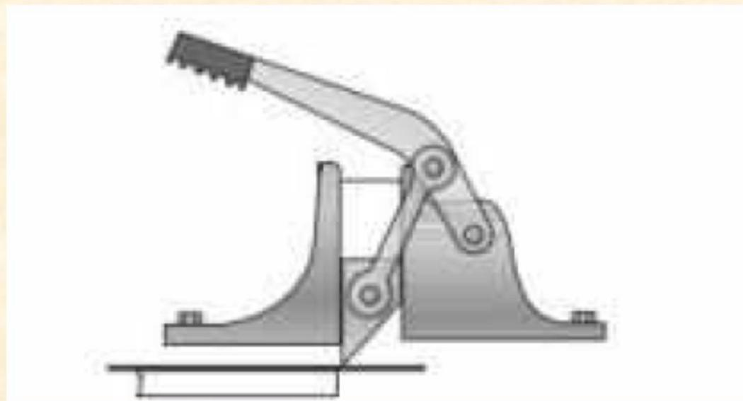
**El primer paso para generar el diagrama cinemático es decidir la parte que se diseñará como la bancada. El movimiento de todos los demás eslabones se determinará en relación con la bancada.**
