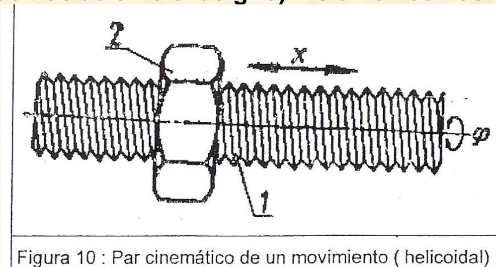
Figura 10 : Par cinemático de un movimiento ( helicoidal)
