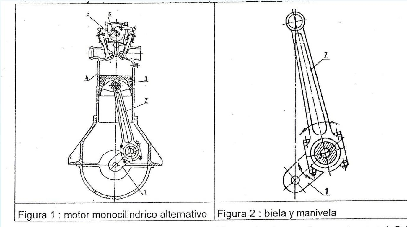
**El mecanismo biela-manivela se utiliza en los motores de combustión interna y permite transformar el movimiento alternativo de un pistón en un movimiento rotativo del cigueñal**
