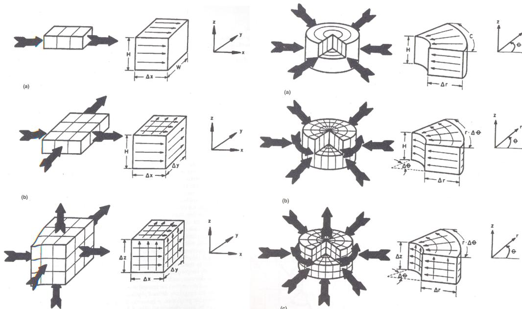
Figura 3.1 Flujo 1D, 2D y 3D en coordenadas cartesianas
