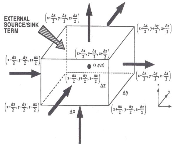
Figura 3.4 Volumen de control en coordenadas rectangulares
