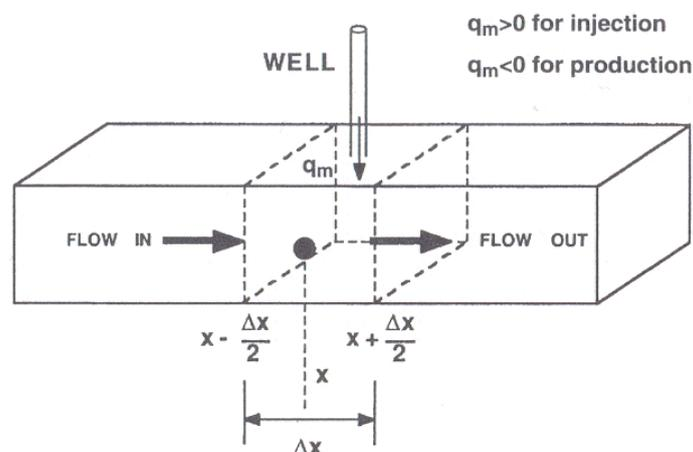
Fig. 1.1 Volumen de control para flujo unidimensional en coordenadas cartesianas
