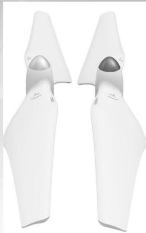
**Dos posiciones diferentes.** Se hace para **contrarrestar el Factor P o Par motor**. El fenómeno Par motor se explica con la **tercera ley de Newton**, en la que se indica que de cualquier fuerza que se ejerza va a resultar otra fuerza igual y de sentido contrario.
