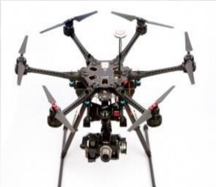
Hexacoptero. 6 motores a 60 grados de separación en un marco simétrico, con tres juegos de motores / hélices CW y CCW
