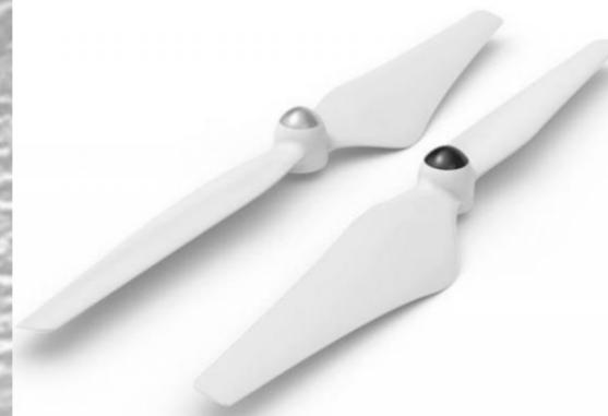
Para compensar este efecto se utilizan **hélices contrarrotatorias**, este es el motivo por el que el Drone dispone dos hélices diferentes en cuanto a la **dirección** de las palas. De esta manera la **fuerza horizontal** que genera cada hélice **se contrarresta** con una hélice opuesta girando en el sentido contrario.
