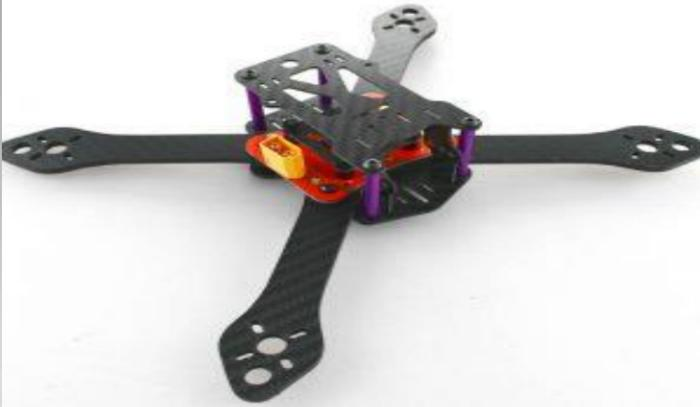
Un quadcoptero tiene 4 motores montados en una estructura simétrica, cada brazo está normalmente a 90 grados de separación. Dos motores giran en sentido horario (CW en inglés) y los otros dos giran en sentido anti horario (CCW) para crear una fuerza opuesta para mantener el equilibrio.
