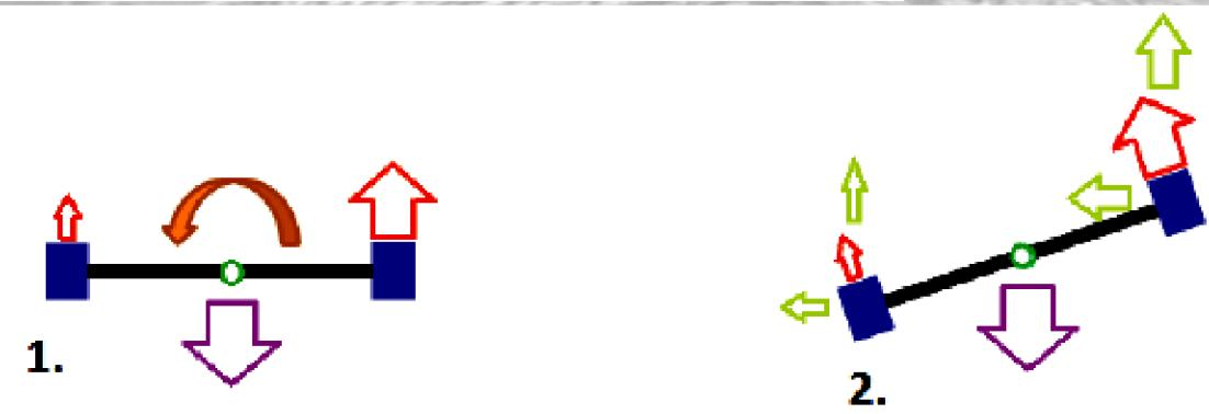
En reposo los dos motores giran igual, y por tanto tienen el mismo empuje, que sólo se invierte en compensar la fuerza con la que la gravedad tira del aparato hacia el suelo. En el momento en el que el motor derecho gira más rápidamente que el izquierdo el sistema dinámico se desequilibra, produciendo que haya un mayor empuje a la derecha que a la izquierda del centro de gravedad, y originando un momento torsor que hace girar el aparato
