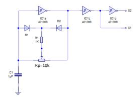
En este circuito la frecuencia de oscilación está determinada por (Rp+R1) y C1. R2 es solamente una protección de entrada de IC1a, que normalmente puede obviarse.
