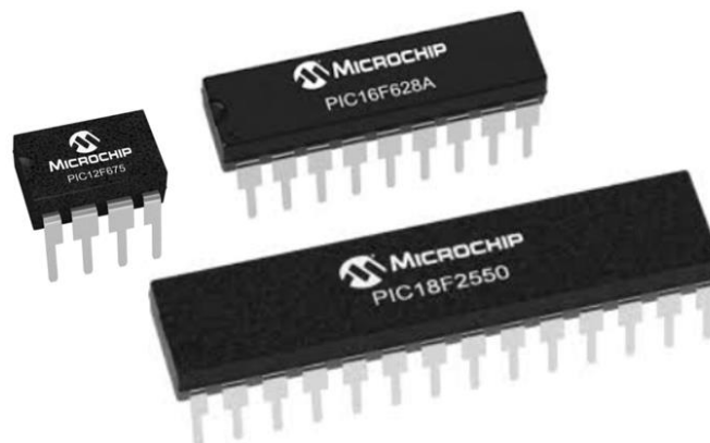
Figura 1. Microcontroladores PIC12F675, PIC16F628A y PIC18F2550 de Microchip.
