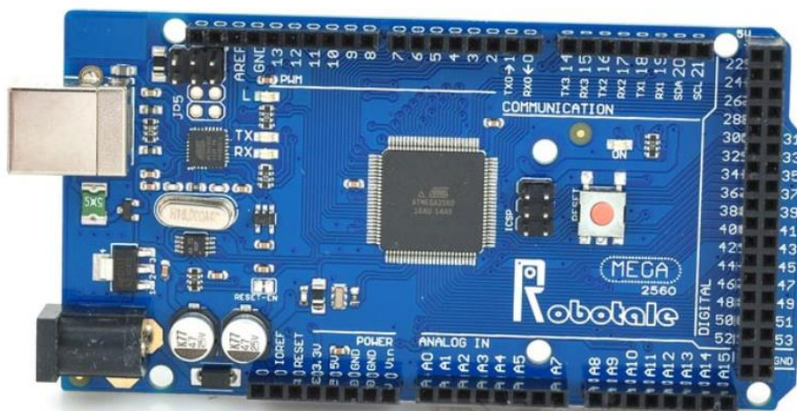
Figura 3. Microcontrolador Atmega2560 en placa ArduinoMega.
