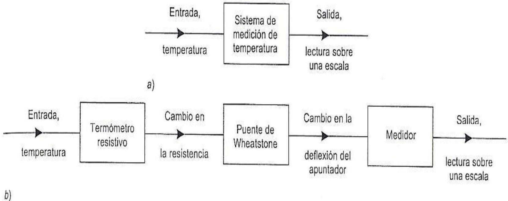
Figura 1.3 a) Sistema de medición de temperatura y b) sus subsistemas
