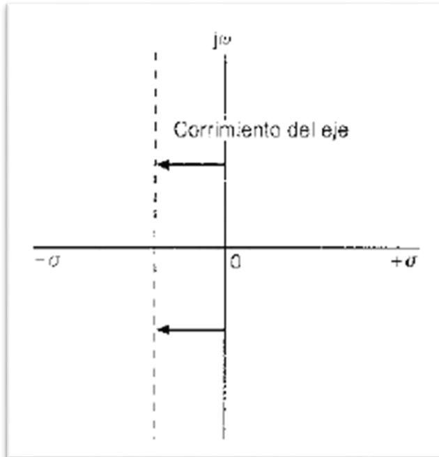
Para lograrlo, hay que ver qué tan cerca del eje imaginario están las raíces. Esto se puede hacer recorriendo el eje a la izquierda una cantidad definida y encontrar si el corrimiento da o no por resultado un sistema inestable medido a partir del nuevo eje.
