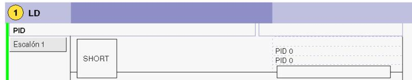
**NOTA:** En una aplicación de automatismo Twido, el número máximo de funciones PID configurables es de 14.
