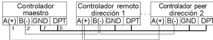
Conexión del bloque de terminales
