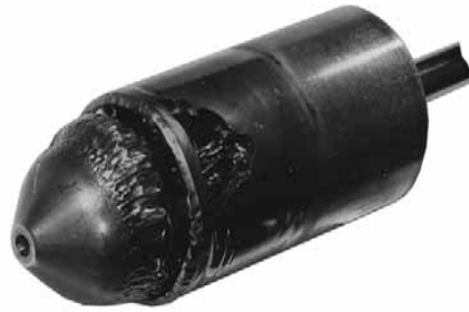
Daños provocados por flashing a un obturador
