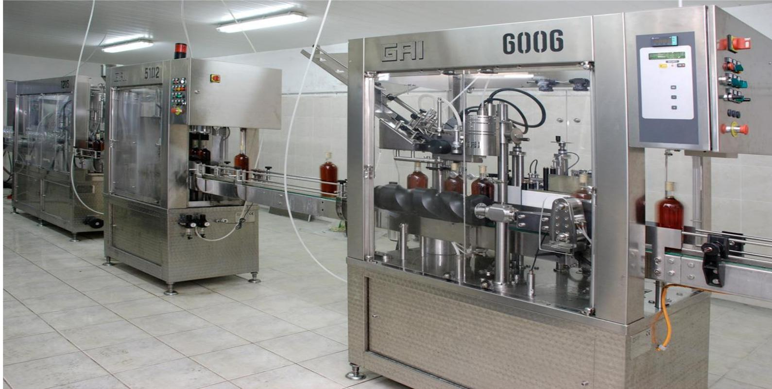
Cada etapa del proceso (llenado, etiquetado, capsulado) es realizado en “islas automatizadas”. Cada isla está controlada por equipos electrónicos (PLC, PID etc).
