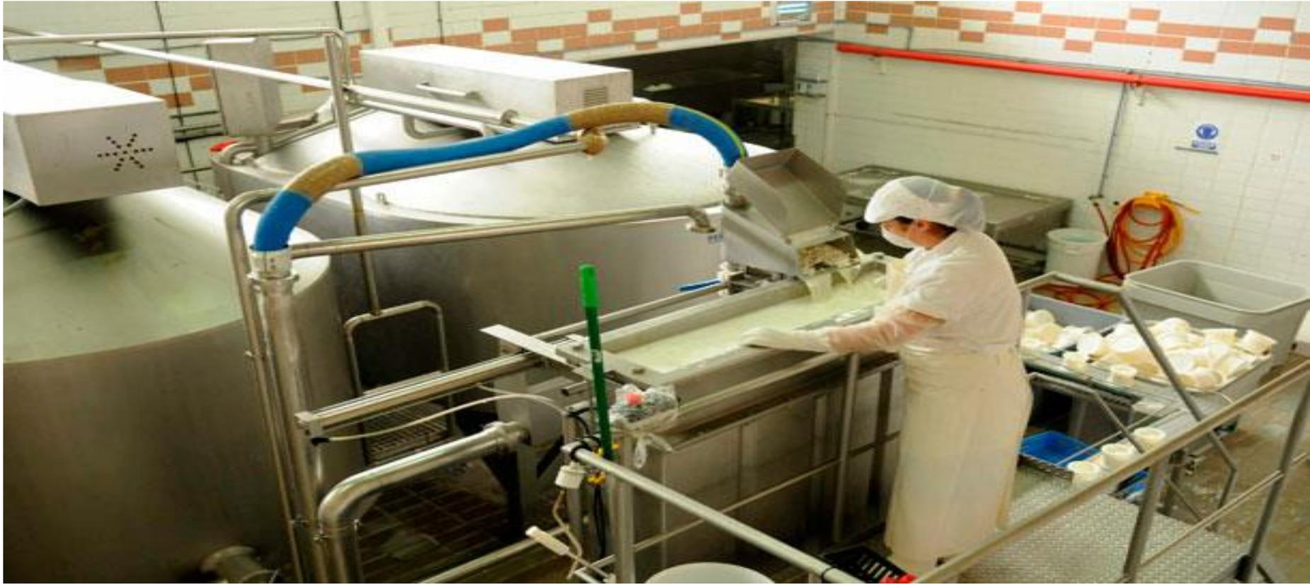
En cada cuba se automatiza la agitación y el calentamiento controlando la velocidad, la temperatura y el tiempo. Habrá elementos de medición o “sensores” (de temperatura, de velocidad etc) y elementos de accionamiento o “actuadores” (motores, resistencias de calentamiento eléctrico o válvulas de paso de gas etc)
