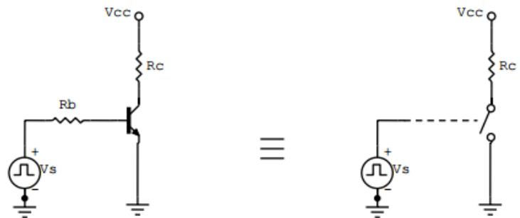
En aplicaciones de potencia, " $R_C$ " puede representar un motor, un relé, el primario de un transformador elevador. En aplicaciones digitales la resistencia se coloca para que el circuito trabaje como **inversor lógico**.
