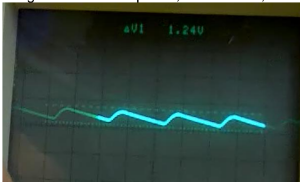
Imagen 5. V_{pk}= 14,45\text{ V} . V_r= 1,24\text{ V} (con C= 470\text{ uF} + 220\text{ uF} )
