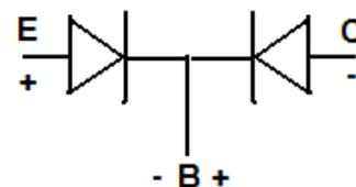
Figura 1: Representación gráfica de un transistor
