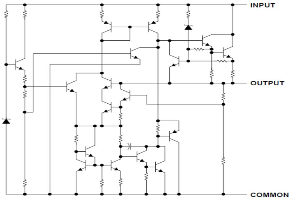
**Figura 12:** Regulador de Tensión Fija 7805
