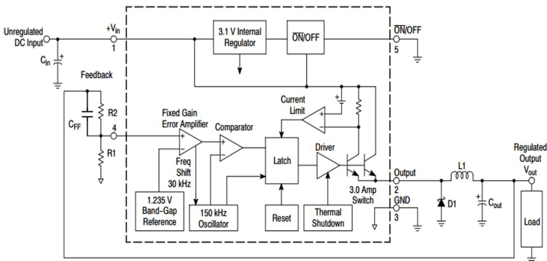
**Figura 13:** Regulador LM2596 (Diagrama en Bloques)
