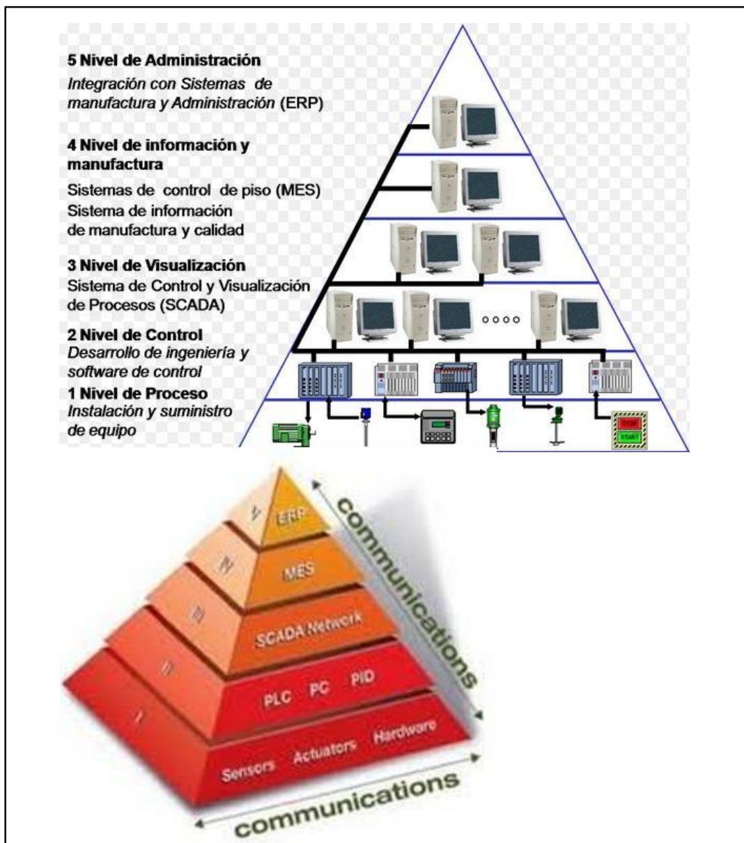
Figura 3. Pirámide CIM con los 5 niveles de automatización.
