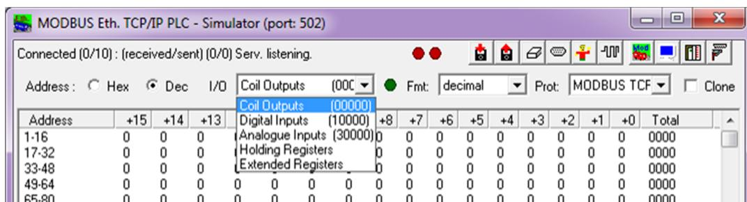
**Coil Outputs:** Actúan como variables Digitales de entrada/salida
