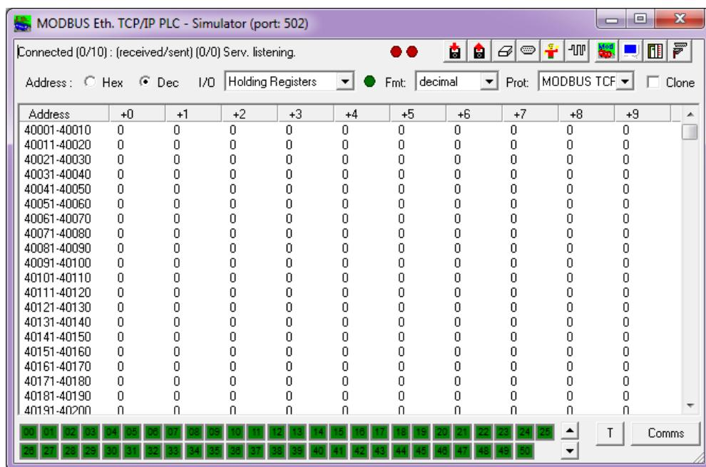
El menú I/O permite seleccionar el tipo de entrada/salida que se desea activar.
