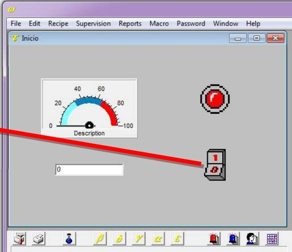
La entrada analógica 1 (*Analogue Input +0*) está asociada con el Vómetro, para cambiar su valor se hace doble clic sobre la posición y en la ventana que aparece se carga el valor.
