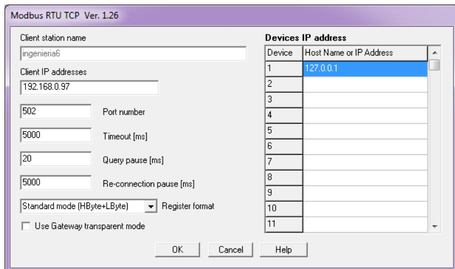
En esta ventana solamente es necesario configurar la dirección IP del dispositivo 1, en este caso por tratarse de un simulador que se ejecuta en la misma PC se utilizará la dirección de red del localhost<sup>1</sup> (127.0.0.1)
