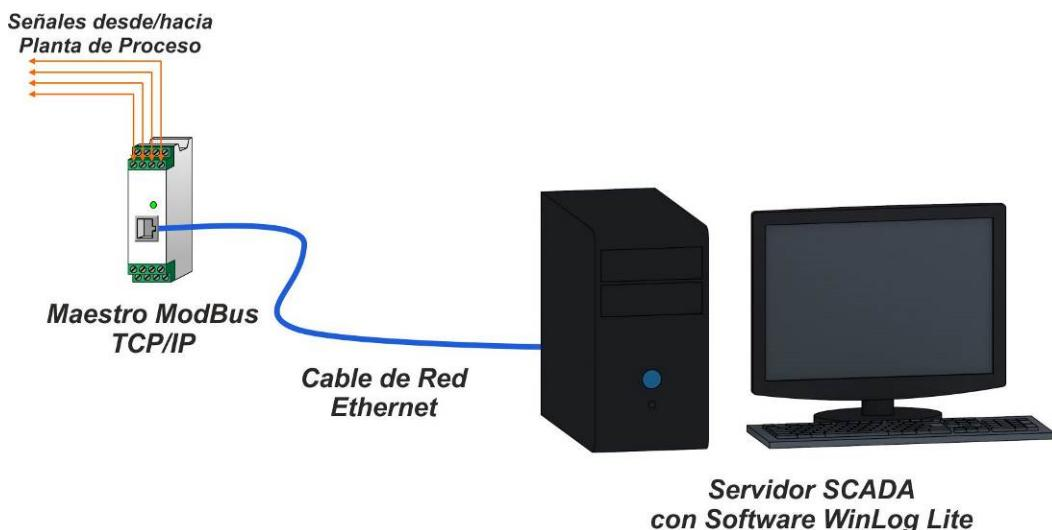
En caso de no disponer de un dispositivo externo es posible utilizar un simulador de ModBus TCP para simular la entrada/salida de datos desde la planta de proceso, e interconectar el mismo con WinLog en forma local (en la misma PC).
