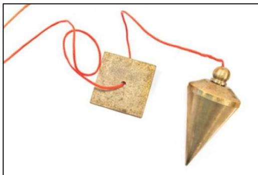
Figura N°7: elementos de la plomada
