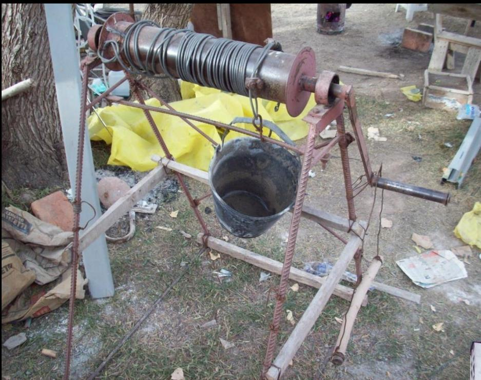
Torno para excavación de pozos
