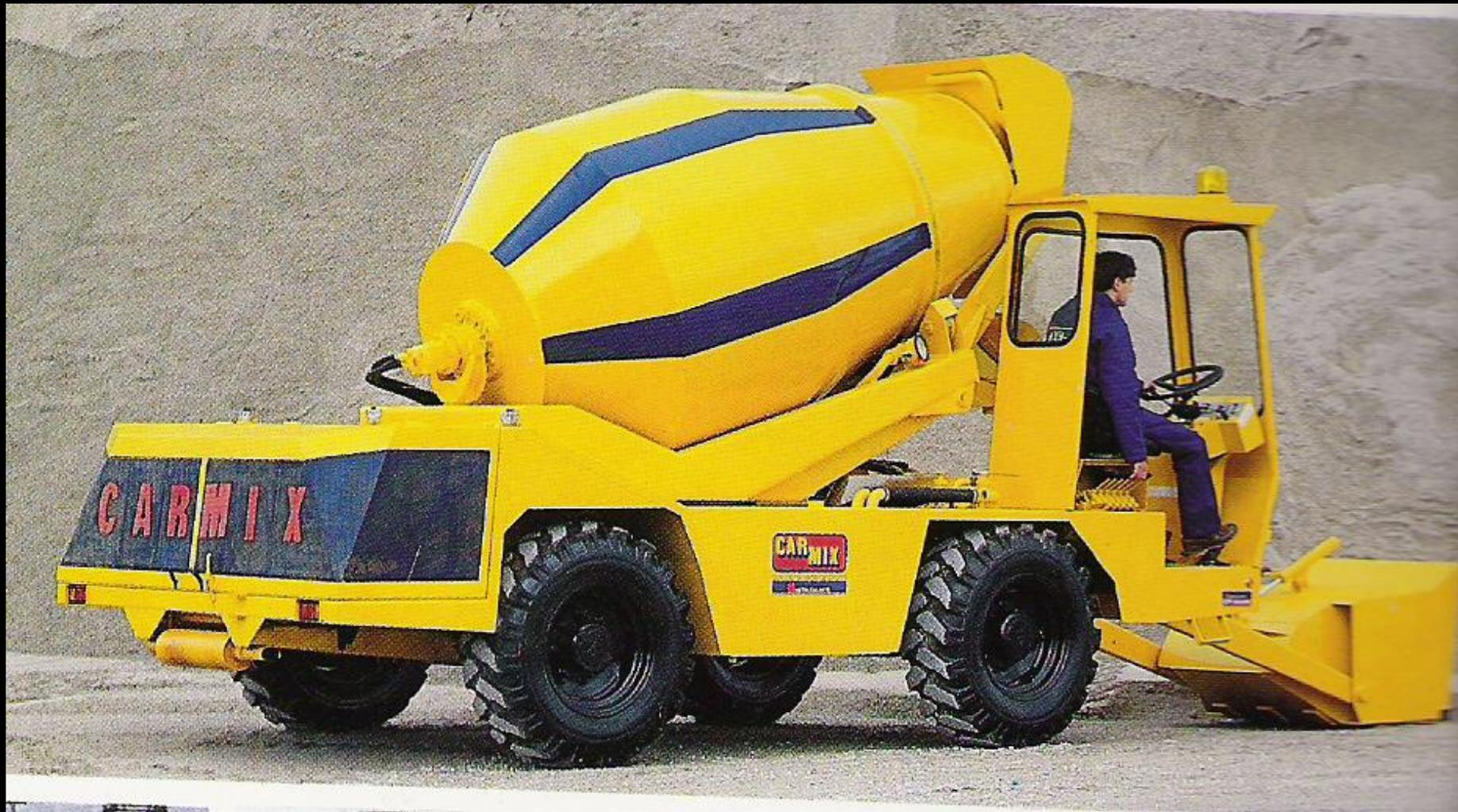
Equipo móvil para carga, elaboración y transporte de hormigón
