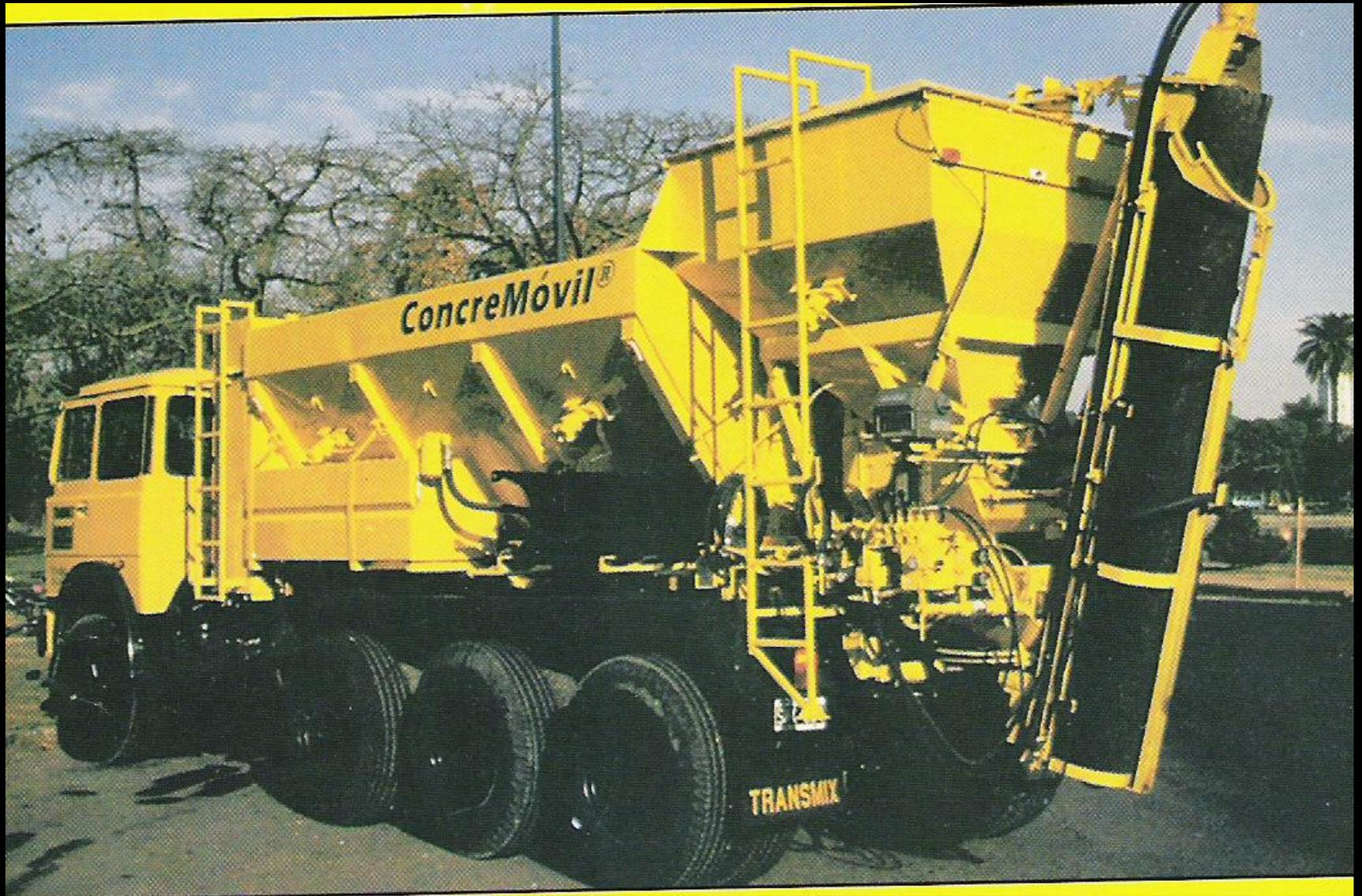
Equipo móvil para carga, elaboración y transporte de hormigón
