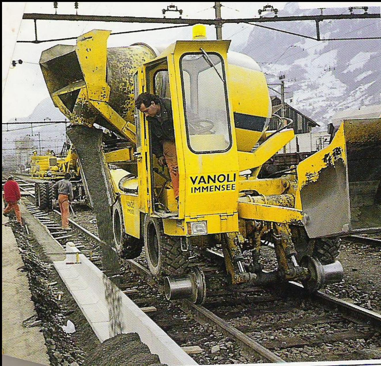
Bomba móvil para transporte y colocación de hormigón
