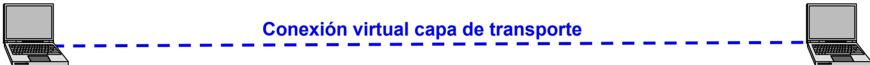
La capa de transporte puede controlar la confiabilidad extremo a extremo, convirtiendo el enlace completo en confiable
