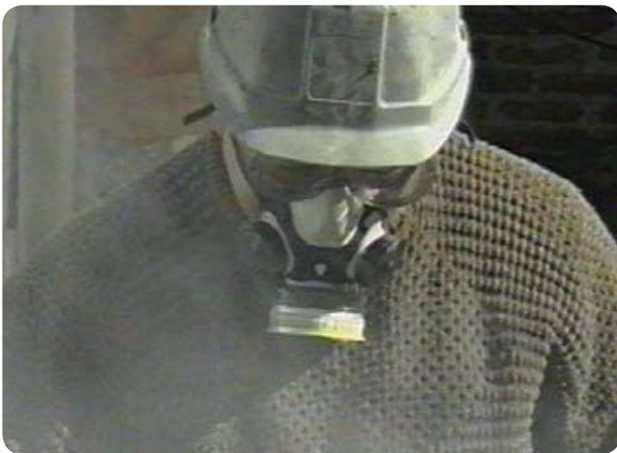
Filtro: de retención química para vapores y gases.
