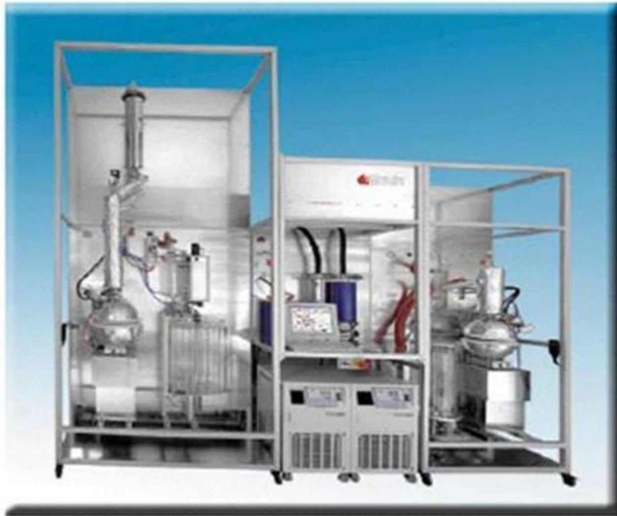
Columna Destilación TBP
