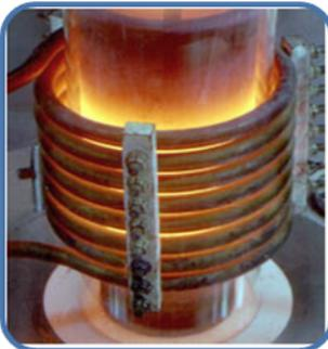
Horno de inducción: sirve para calentar una pieza, hacer un tratamiento térmico o modificar de alguna manera la estructura cristalográfica.
