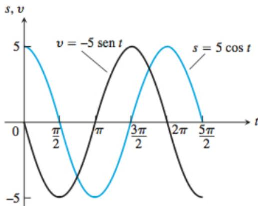
Si el movimiento es modelado por  $s(t) = 5 \cdot \cos(t)$ , entonces podemos determinar la velocidad  $v(t) = -5 \cdot \sin(t)$  y su aceleración  $a(t) = -5 \cdot \cos(t)$  en cada instante.
