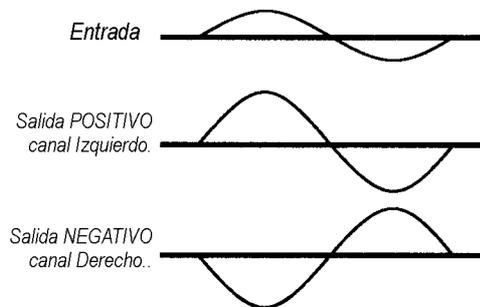
Un amplificador puenteado es conectado normalmente como lo muestra la figura a continuación. Generalmente, los parlantes se conectan a los dos terminales positivos (*uno de cada canal*). La salida izquierda es normalmente la conexión positiva y la salida derecha es la conexión negativa.
