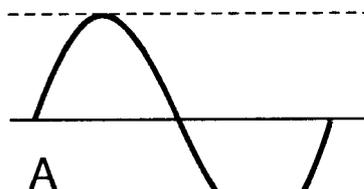
Nivel ajustado de manera que la señal de audio está por debajo de la capacidad máxima del circuito.
