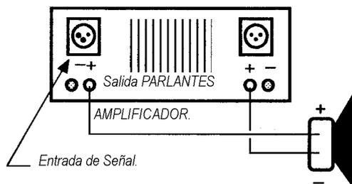
**Nota:** la especificación dada anteriormente nos brinda información referida a una impedancia de 8 Ohms únicamente. Esto es así, porque, la impedancia mínima en modo puente es el doble de la requerida en modo stereo.
