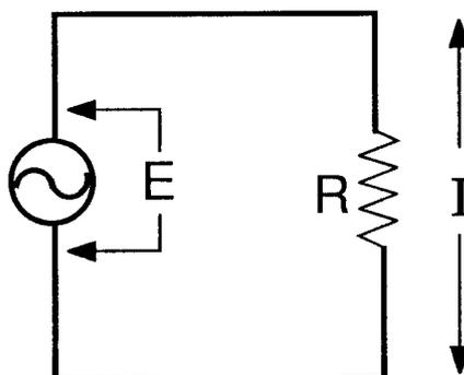
Una de las aseveraciones de la Ley de Ohm indica que **la corriente es inversamente proporcional a la impedancia**; es decir, a menor impedancia, mayor intensidad de corriente y viceversa.
