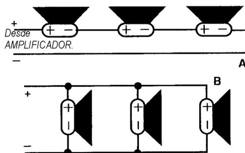
Cuando dos ó más parlantes están conectados en serie **(A)**, la corriente desde el amplificador pasa en forma serial de un parlante a otro, y la impedancia neta del sistema es la suma de las impedancias de cada uno de los parlantes conectados en esta manera. Es decir, **para 3 parlantes de 8 Ohms cada uno de impedancia conectados en serie, la impedancia total a la salida del amplificador sería:  $8 + 8 + 8 = 24 \text{ Ohms}$ .**
