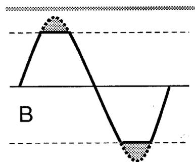
Nivel ajustado de manera que la señal de audio es levemente superior a los límites del circuito. "CLIPS".
