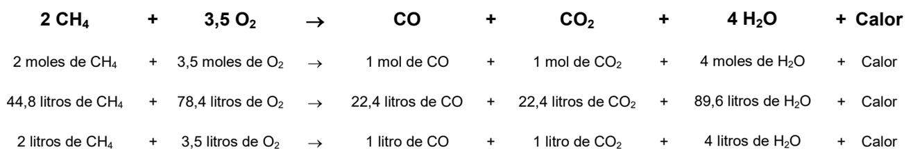
El anhídrido carbónico es un producto final de una combustión completa y no contiene energía calorífica que pueda ser liberada por medio de una combustión ordinaria.
