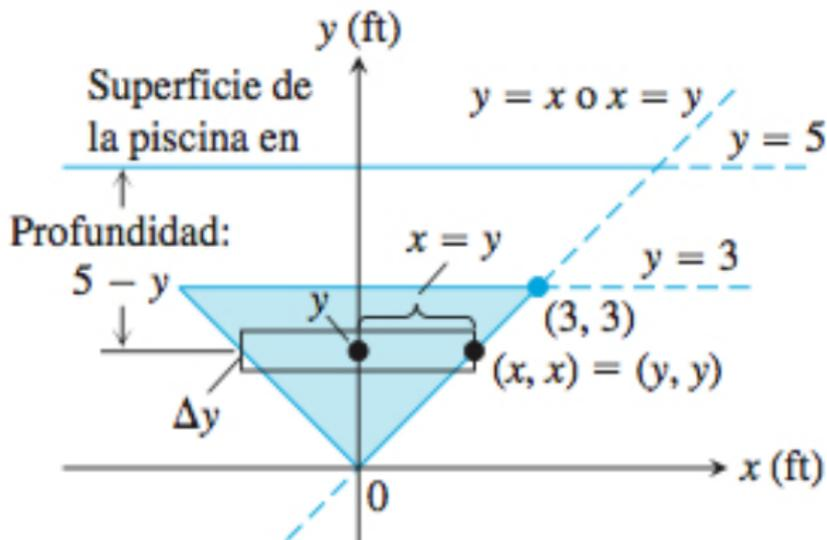
**Solución:** siguiendo la figura, ubicamos el eje  $x$  en el vértice inferior de la placa (otras elecciones son posibles). Entonces la superficie del líquido queda a una altura de  $y = 5$ . Eligiendo una sección delgada, representativa, de la placa a altura  $y$ , obtenemos que la profundidad de la misma es
