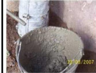
Cada muestra se tomará directamente de la canaleta de descarga de la motohormigonera.
