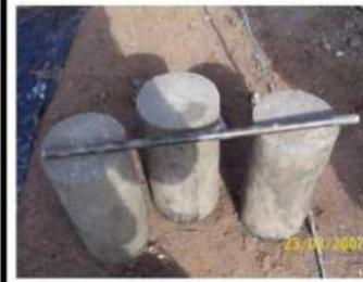
La compactación del hormigón en los moldes se hace mediante una varilla con las siguientes dimensiones.
