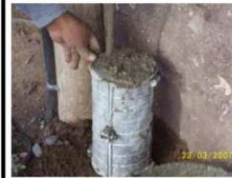
El llenado de la última capa se hace con un exceso de hormigón para facilitar el enrase de la probeta.
