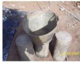
La muestra se tomará en un recipiente limpio y estanco, y se remezclará antes del llenado de la probeta.
