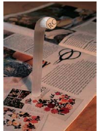
33.16 Transmisión de imágenes por un haz de fibras ópticas.
