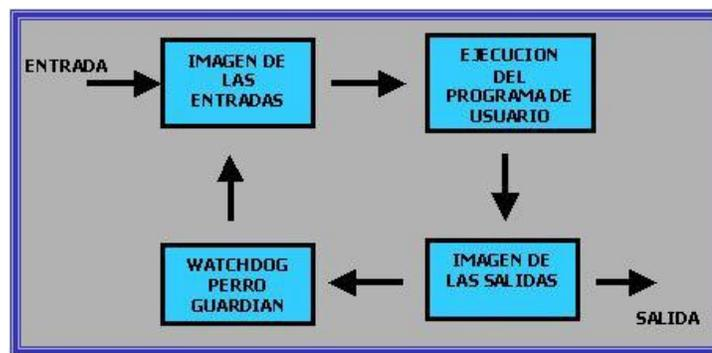
**Figura 3. Ciclo de trabajo del Microprocesador**
