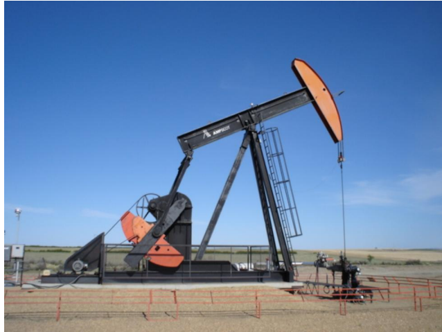
Figura 19: Equipo de bombeo de petróleo
