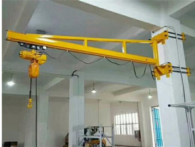
Figura 10: Viga en voladizo
